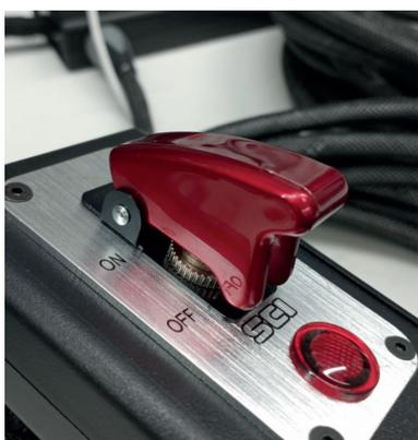
7. Для завершения работы подавителя закройте защитный колпачек. Кнопка выключится автоматически.
